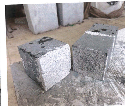
Σχήμα 2.15: Τρόπος αστοχίας δοκιμίου 2 σε απλή κάμψη.
