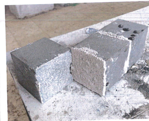
Σχήμα 2.14: Τρόπος αστοχίας δοκιμίου 1 σε απλή κάμψη.
