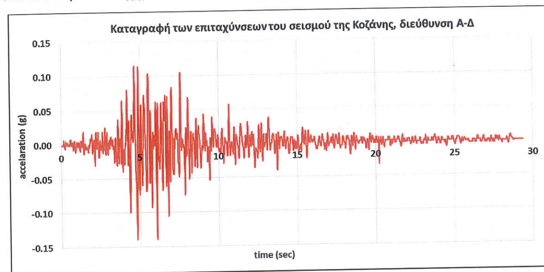
Σχήμα 4.4. Καταγραφή των επιταχύνσεων του σεισμού της Κοζάνης, διεύθυνση Α-Δ
