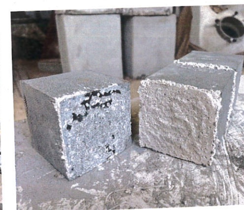
Σχήμα 2.16: Τρόπος αστοχίας δοκιμίου 3 σε απλή κάμψη.
