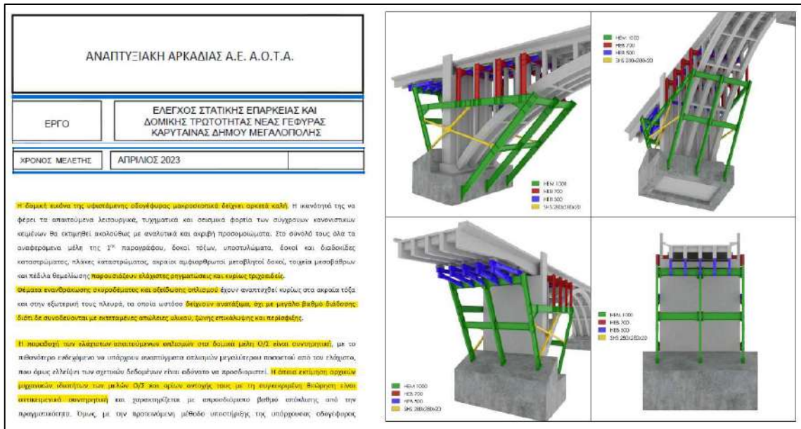
Εικ. 46 Έλεγχος στατικής επάρκειας και της δομικής τρωτότητας της νέας γέφυρας Καρύταινας.
