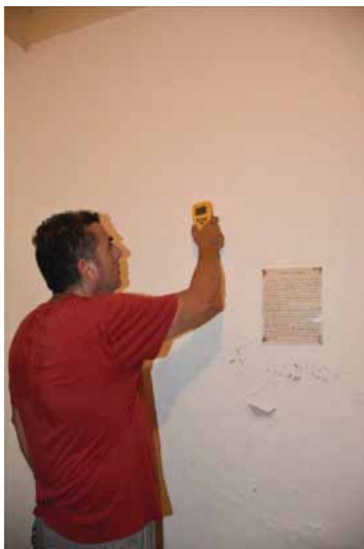
Φωτ. 67 Σάρωση των κατακόρυφων τοίχων με το υγρόμετρο και καταγραφή των ποσοστών υγρασίας.
