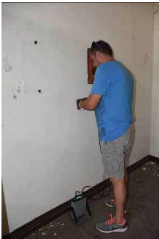
Φωτ. 71 Μέτρηση με τη συσκευή υπερήχων για τον έλεγχο στερεότητας των κονιαμάτων. Η τιμή 75,0μS φανερώνει ότι η περιοχή παρουσιάζει προβλήματα στερεότητας.
