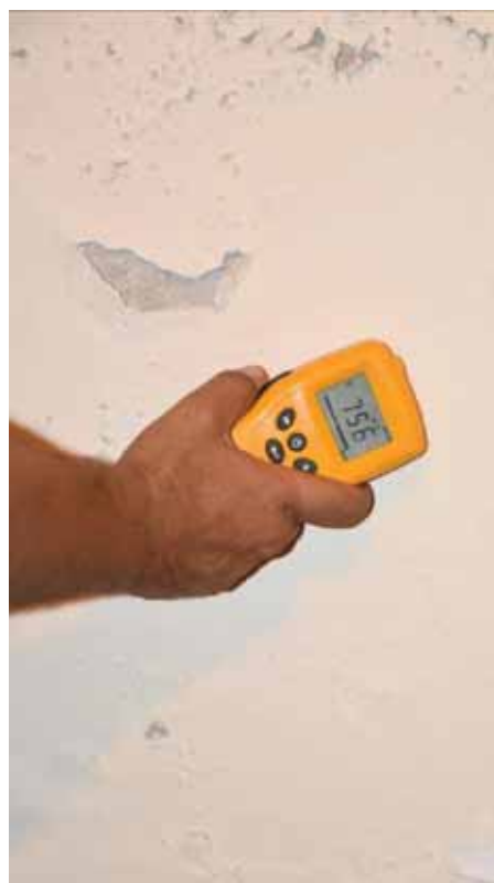
Φωτ. 67 Σάρωση των κατακόρυφων τοίχων με το υγρόμετρο και καταγραφή των ποσοστών υγρασίας.
