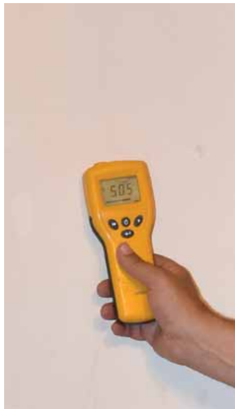
Φωτ. 66 Σάρωση των κατακόρυφων τοίχων με το υγρόμετρο και καταγραφή των ποσοστών υγρασίας.
