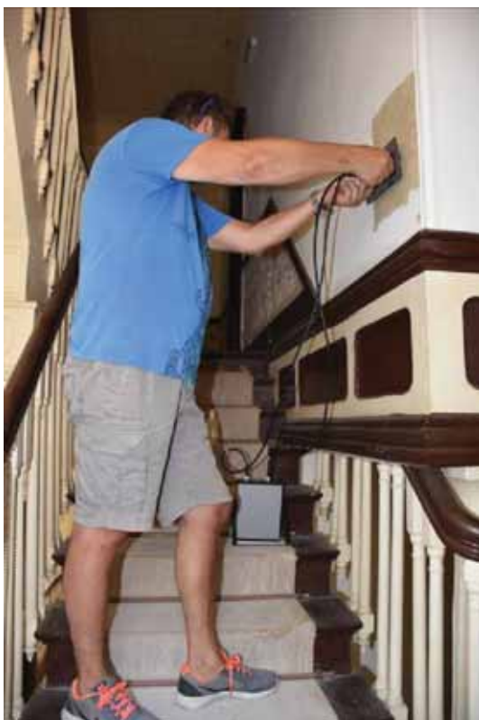
Φωτ. 70 Μέτρηση με τη συσκευή υπερήχων για τον έλεγχο στερεότητας των κονιαμάτων. Η τιμή 62,5μS φανερώνει ότι η περιοχή παρουσιάζει προβλήματα στερεότητας.
