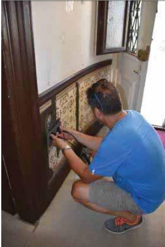
Φωτ. 69 Μέτρηση με τη συσκευή υπερήχων για τον έλεγχο στερεότητας των κονιαμάτων. Η τιμή 67,5μS φανερώνει ότι η περιοχή παρουσιάζει προβλήματα στερεότητας.
