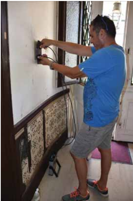
Φωτ. 68 Μέτρηση με τη συσκευή υπερήχων για τον έλεγχο στερεότητας των κονιαμάτων. Η τιμή 55,5\mu\text{S} φανερώνει ότι η περιοχή δεν παρουσιάζει προβλήματα στερεότητας.
