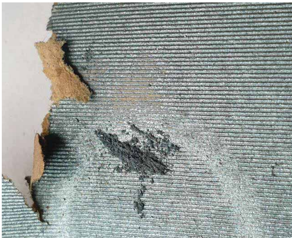
Φωτ. 194 Παρατήρηση με ψηφιακό μικροσκόπιο \times 10 . Απόξεση της μεταλλικής χρωστικής της επιφάνειας.
