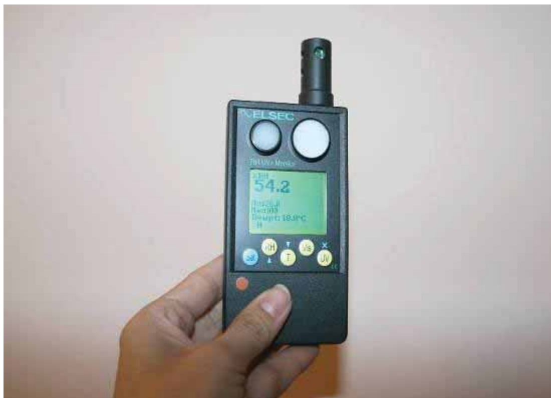
Φωτ. 65 Ηλεκτρονικός θερμοϋδρογράφος Elsec 764 Environmental Monitor που χρησιμοποιήθηκε για την καταγραφή των περιβαλλοντικών συνθηκών του αρχοντικού.
