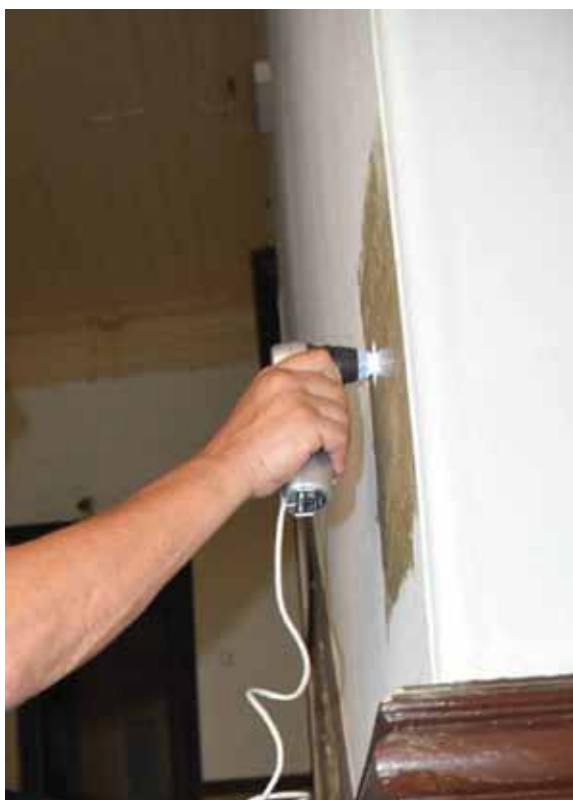
Φωτ. 73 Φωτογράφιση με ψηφιακό μικροσκόπιο σε μεγέθυνση 100x της πατητής κονίας του χώρου του κλιμακοστασίου.
