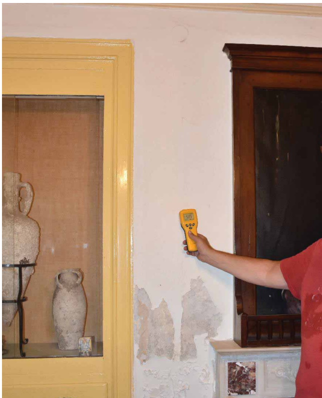
Φωτ. 66 Σάρωση των κατακόρυφων τοίχων με το υγρόμετρο και καταγραφή των ποσοστών υγρασίας.
